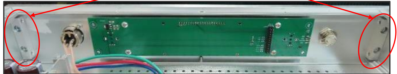
側面の板の固定が完了したら、フロントパネル側の固定金具のネジの増し締めを行う 4か所
