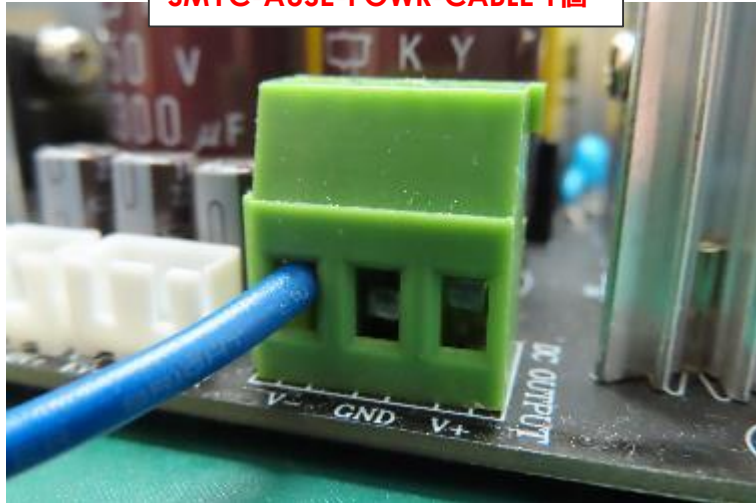
電源基板 SMYC-AUSE-POWER-PCBA 1個 3Pハーネス SMYC-AUSE-POWR-CABLE 1個
